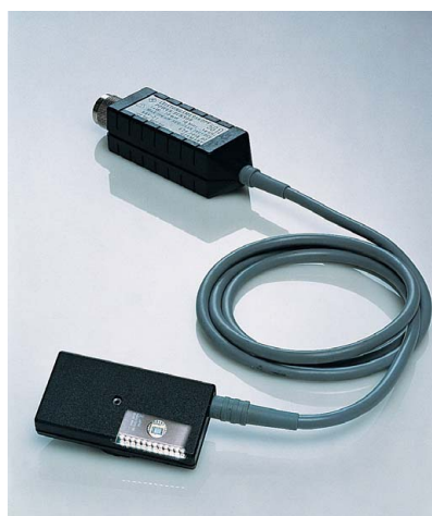
Die für eine individuelle Kalibrierung benötigten Daten sind für jeden Messkopf in einem EPROM im Anschlussstecker gespeichert (Foto 37902)
