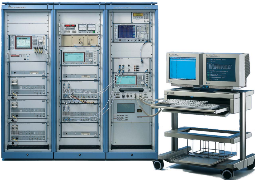
Testsystem R&S TS8916B mit der Option „Audio“ für alle GSM-Standards (Foto 43211-2)
