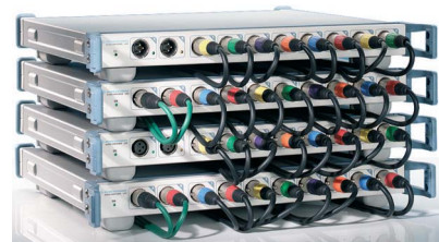
Mit dem Audio Switcher R&S UPZ können bis zu 128 Eingangs- und 128 Ausgangskanäle kaskadiert werden
