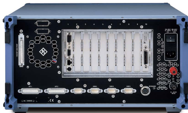
Eine ganze Reihe von Schnittstellen sind bereits im Grundgerät enthalten: Ethernet, Ultra-/Ultrawide-SCSI, 16-bit-GPIB; vielseitige Zusatzfunktionen gestattet der Factory User Port
