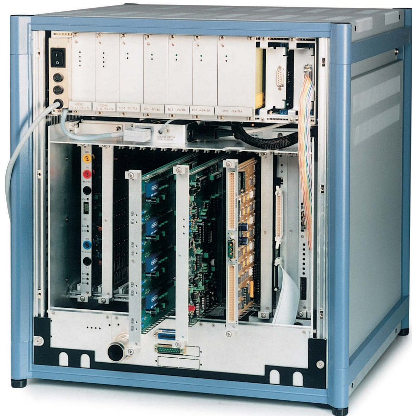
Stimulus- und Messmodule werden an der Geräterückseite des R&S TSA eingeschoben (Foto 38860)
